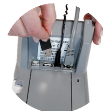
Anschluss des ORGA Protect durch Stecken des USB-Steckers in die USB-A Buchse des ORGA 6141.
