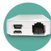
Anschluss RJ45 und USB-Speisung
